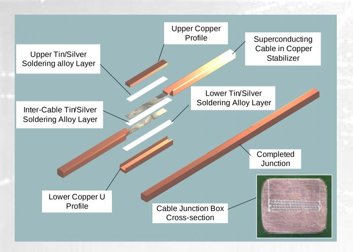
Questi giunti presentano una resistenza piccolissima in presenza di Superconduttivita'. Se pero' accidentalmente la Superconduttivita' sparisce ("quench"), una corrente notevole (9000 A) puo' passare in queste connessioni
